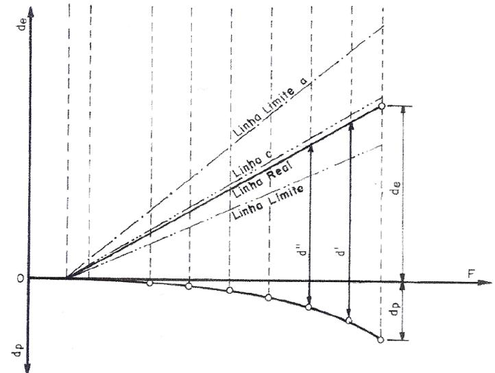
Figura A.4-b) - Repartição em deslocamentos elástico e permanente
