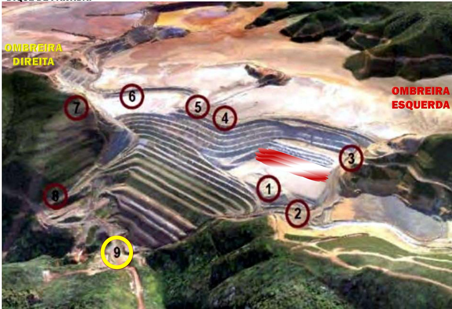
**TRABALHADORES NAS POSIÇÕES 1 e 2 FORAM OS PRIMEIROS A VER A RUPTURA SE INICIAR PERTO DO DRENO DA OMBREIRA ESQUERDA ONDE ESTAVAM, ESTIMANDO A HORA EM 15:45. UM JATO SÚBITO DE ÁGUA SUJA “EXPLODIU” PARA FORA DO DRENO. A PRIMEIRA MOVIMENTAÇÃO E RACHADURAS TAMBÉM FORAM RELATADAS NO DRENO EXPOSTO E AO LONGO DA BORDA DO PLATÔ ADJACENTE, COLOCANDO A SAÍDA DA SUPERFÍCIE DE RUPTURA NA ELEVAÇÃO DE 857 M OU PRÓXIMO A ESTA.**
