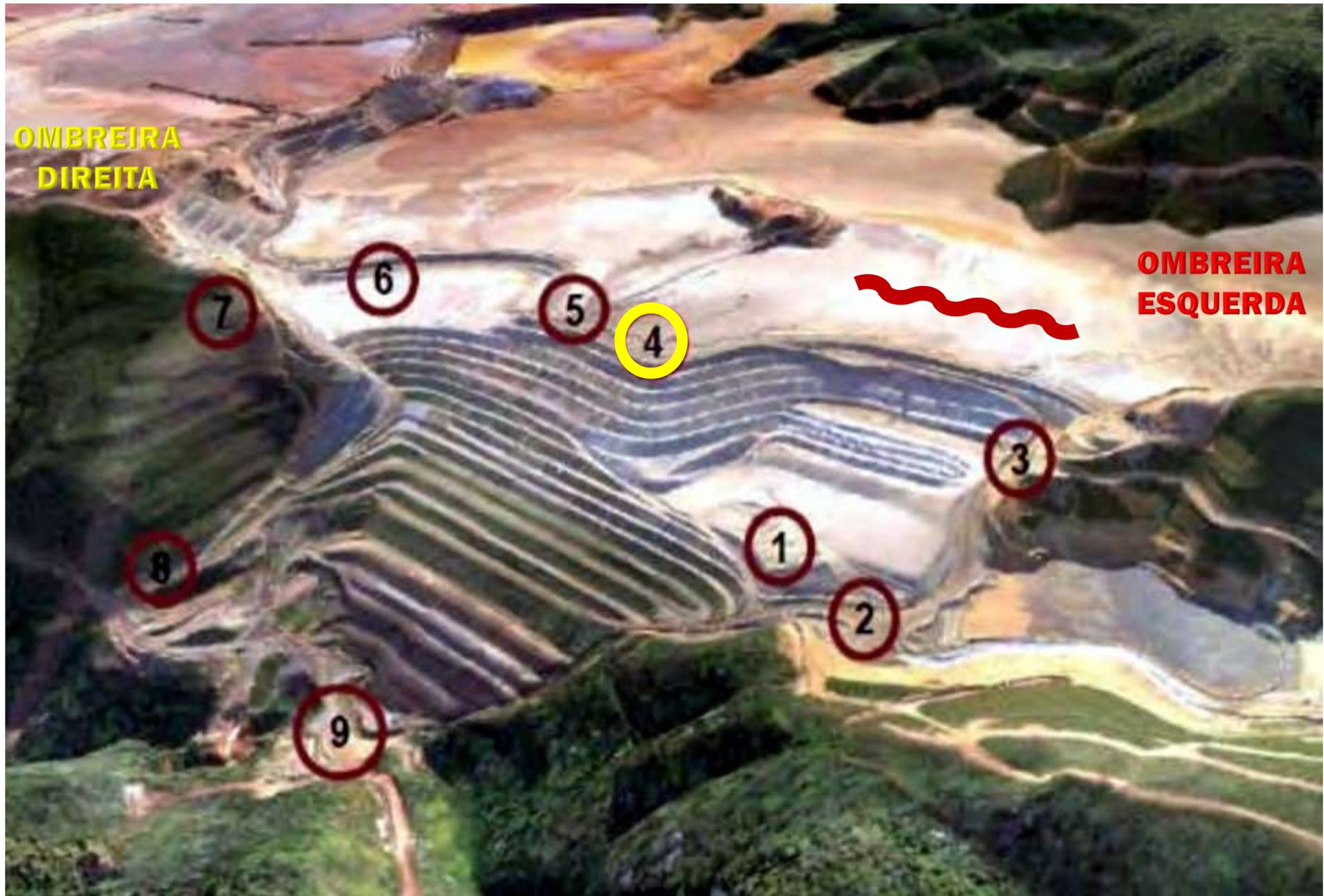
**TRABALHADOR NA POSIÇÃO 5 VIU UMA TRINCA SE ABRIR AO LONGO DA CRISTA DO RECUO DA OMBREIRA ESQUERDA, EM SEGUIDA, SE PROPAGAR EM AMBOS OS SENTIDOS, E ENTÃO PROGREDINDO PARA A DIREITA.**
