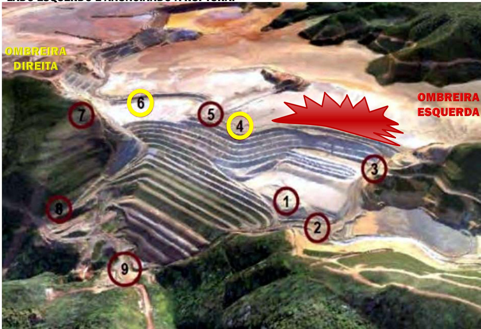
**TRABALHADOR DA POSIÇÃO 4 OBSERVOU ONDAS SE FORMANDO NA POSIÇÃO CENTRAL DO RESERVATÓRIO**
