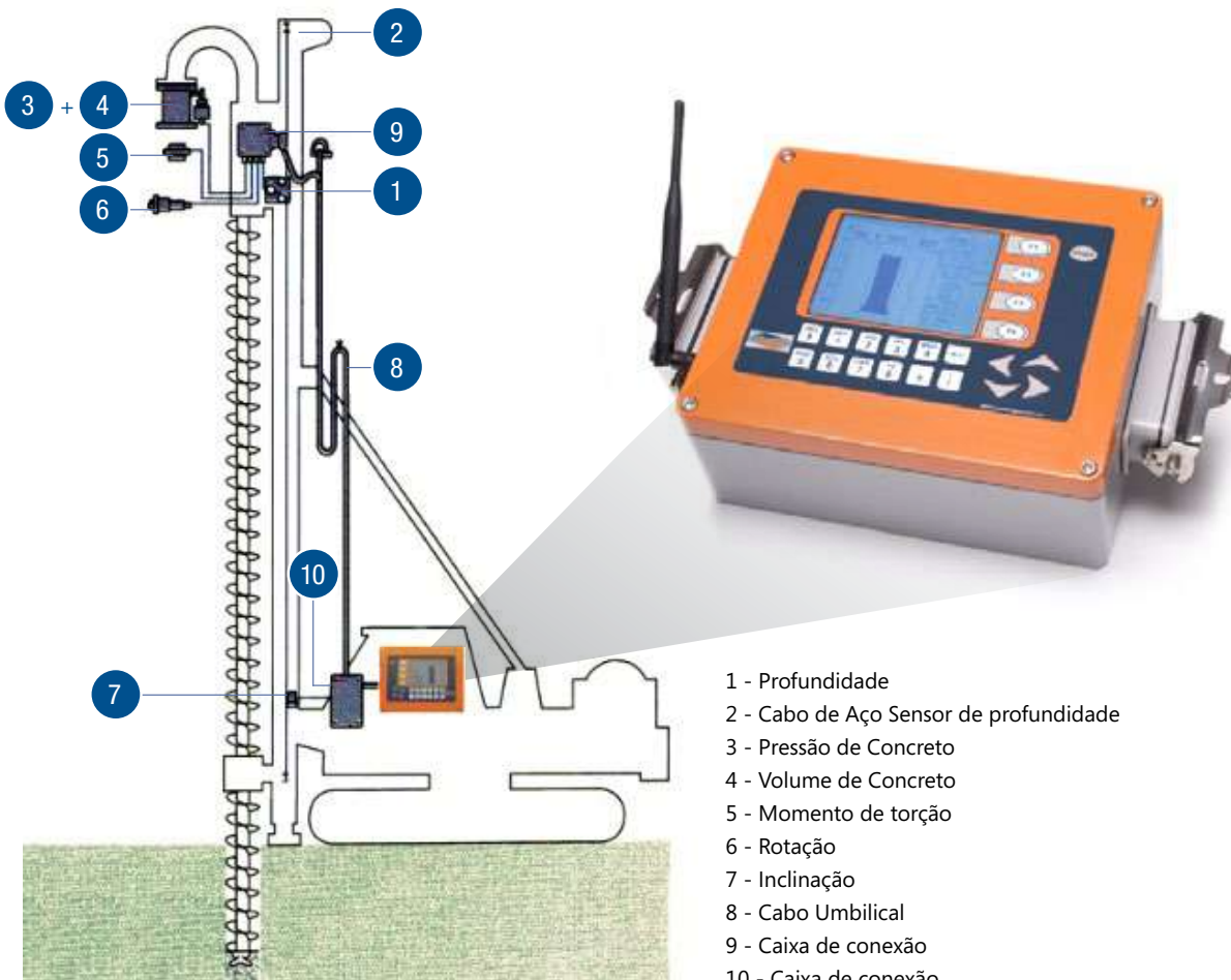
Figura 3: Disposição dos sensores na perfuratriz
